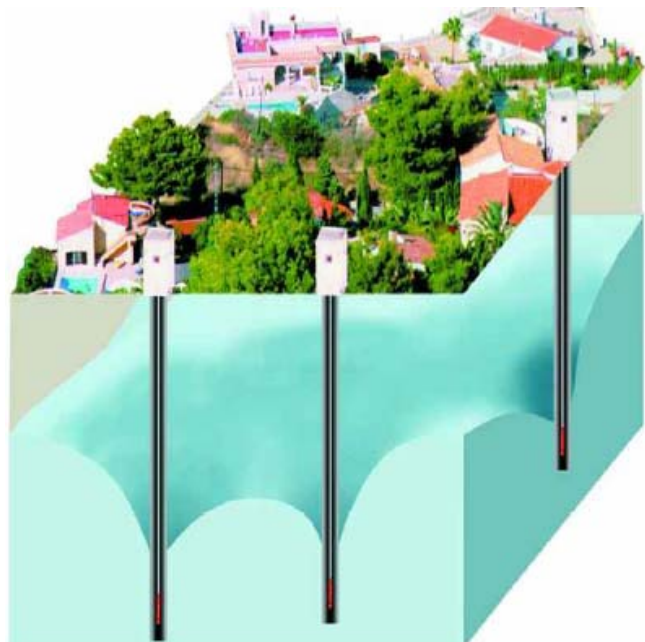
Fig 7 – CONO DE DEPRESION EN UN BOMBEO
