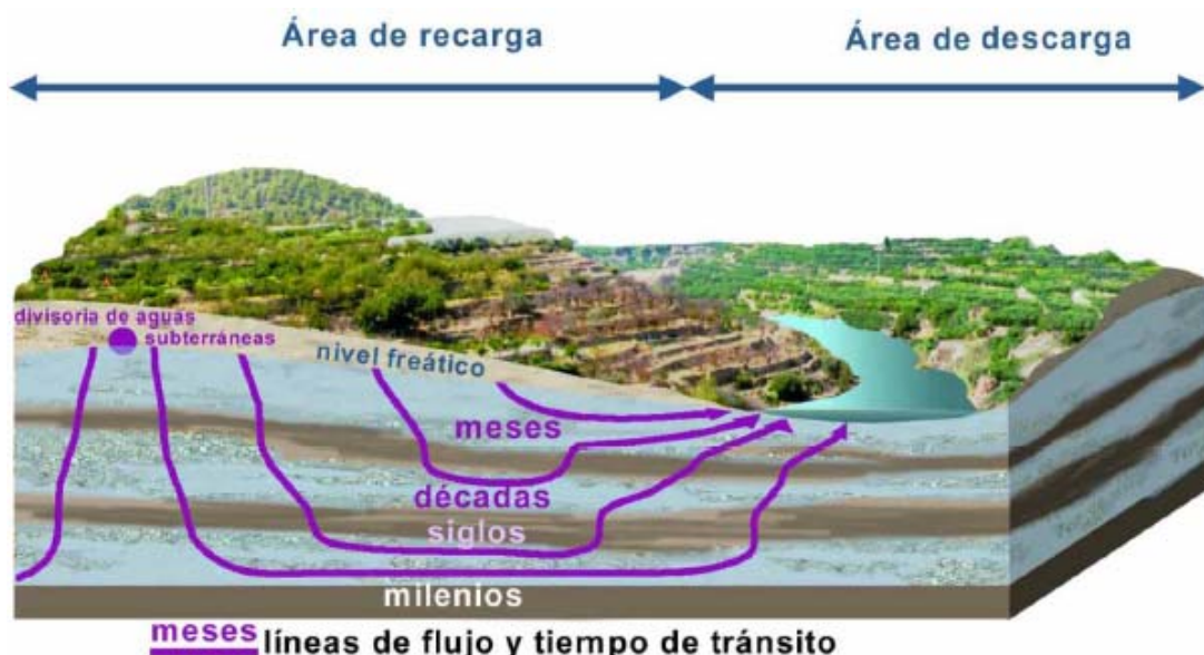
Fig. 4 – ÁREAS DE RECARGA Y DESCARGA
